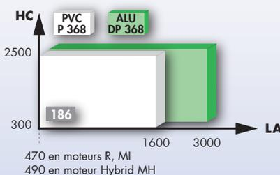
186 hauteur caisson h - Unité de mesures : millimètre
