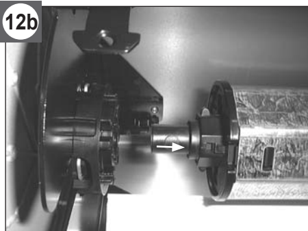
12b Faites rentrer l'embout à l'intérieur de l'axe. Schieben Sie die Endkappe in die Welle hinein.
