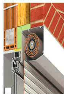
Montage spécifique, en tableau, façade brique (système.XP)
