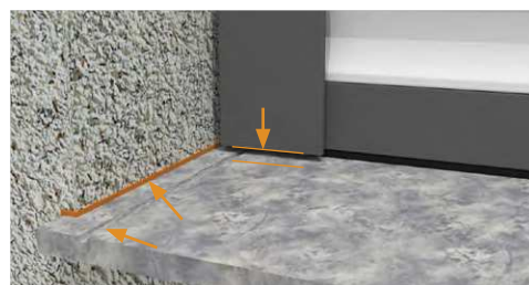
Coulisse non crépie avec appui de fenêtre en pierre
